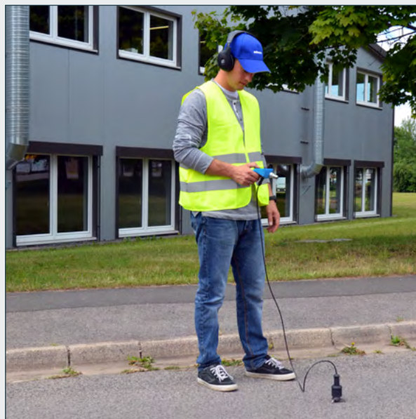
Bodové upresnenie úniku pomocou mikrofónu PAM B-2
